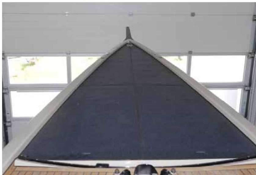
Auf Wunsch kann das komplette Vordeck als begehbare Solarpanel gestaltet werden, eine interessante Entwicklung für Boote mit E-Antrieb, besonders für Boote auf Trinkwasserseen.
