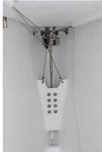
**Die Rollanlage der Fock ist unter Deck platziert.**
