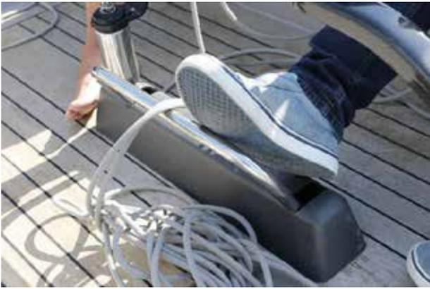
**Eine Konsole mit Klappbügel auf dem Cockpitboden dient als Fußstütze und Podest für die Großschot, sie liegt jederzeit gut zur Hand.**
