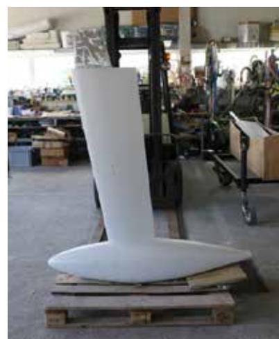
**Der Kiel aus einem Stahlskelett mit GfK-Profilen, die Bombe aus Blei.**
