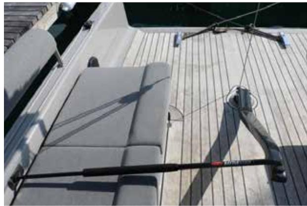
**Der Teleskopausleger kann in einen Beschlag in der Cockpit-Seitenwand eingehängt werden und funktioniert dann als Pinnenarretierung.**
